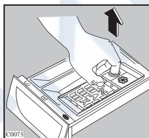
Стиральный порошок может также скапливаться в отсеке, в котором устанавливается дозатор: прочищайте его с помощью старой зубной щетки. После чистки установите дозатор на место.
