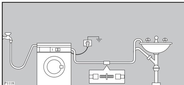
**Для обеспечения правильной работы машины сливной шланг должен быть всегда подвешен за соответствующий кронштейн, расположенный в верхней части задней панели машины.**
